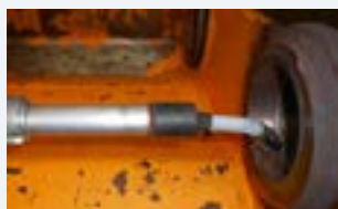
Applications aléseuses Rechargement avec la SUPERCOMBINATA
