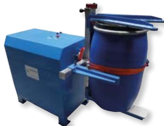
Pince manuelle ou à commande électrique 1 axe 2 formats (50 à 250l ou 100 à 250l)
