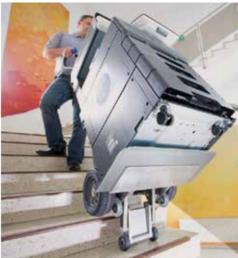
Bras motorisé assurant l'élévation
