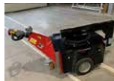
IBOOST Tracte jusqu'à 25 T sur roue et jusqu'à 80 T sur rail.
