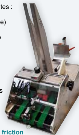
Margeur à friction avec guides spécifiques
